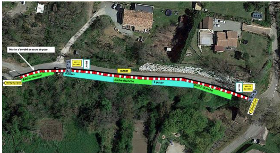
Figure 27 : Sites d'effondrement de la RD 58F à Saint-Cézert, source : données communales.
